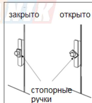
Если часть стопорной ручки выступает дальше ручки, дверь не будет закрываться полностью, поэтому установите ее параллельно ручке.
