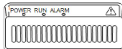
Загорится индикатор **RUN** (РАБОТА) на ионизаторе, и начнется ионная эмиссия. Время ионной эмиссии настроено на 10 секунд (настройка по умолчанию при отправке с завода). Эмиссия ионов прекратится автоматически после истечения времени, установленного для ионной эмиссии.
