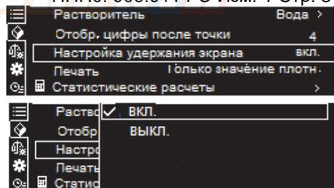
\* Значение удельного веса твердого тела будет удерживаться после того, как оно было определено, если настройка удержания экрана установлена на «вкл.», и будет отображаться до тех пор, пока не будет нажата кнопка **OK**.
