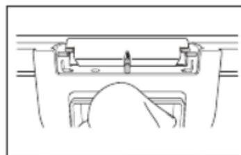
**5** Отрегулируйте высоту установки экрана. При отпускании рычажка на ручке, экран фиксируется в установленном положении.
