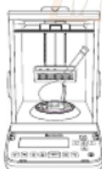
При взвешивании веществ на медицинской упаковочной бумаге с использованием мультиподставки, экран опускают ниже для снижения влияния восходящих воздушных потоков воздуха на результат измерения
