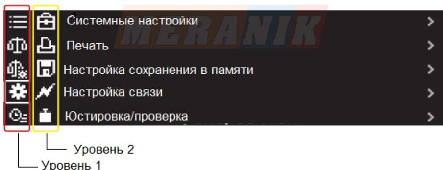
Рисунок 5 – Дисплей меню при выборе настройки системы
