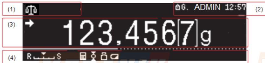
Рисунок 4 – Дисплей весов (изображение для режима стандартного взвешивания)
